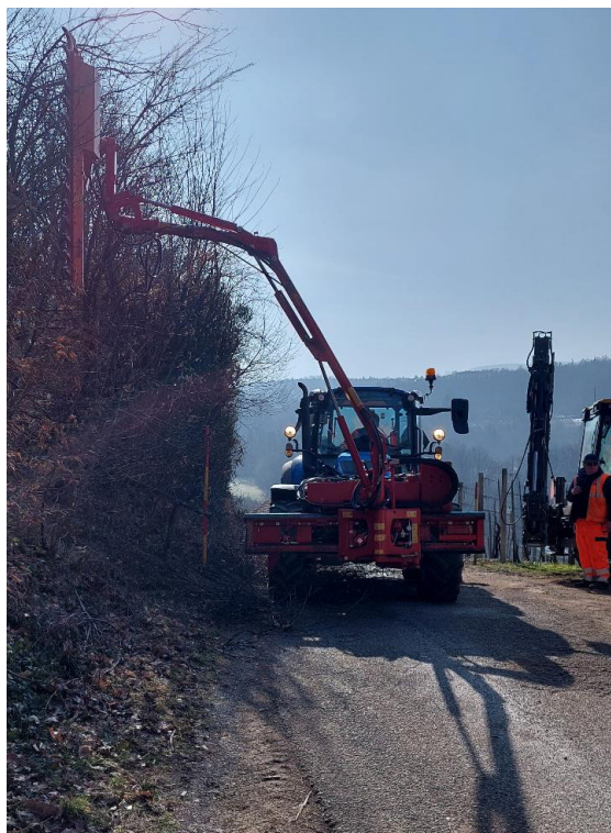
Slika 3 - prikaz strojnega obsekovanja
